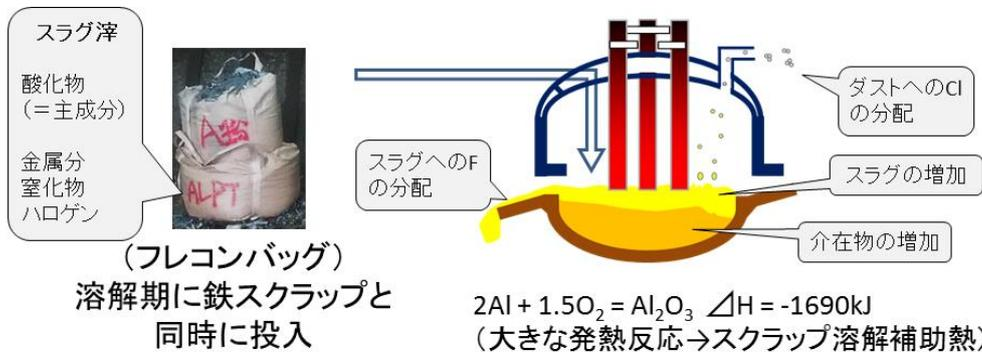
JIS規格（JIS G 2402：2015 鉄鋼用アルミニウムドロス）に規定されているアルミドロスの内、金属アルミニウムを主成分とする規格は1種～7種まで分類されています。金属アルミニウムの含有率の低いアルミドロスの1種・2種の製品は、発熱材や脱酸剤として使用すると、鉄鋼スラグ滓の発生量が増加するため、製鋼スラグ滓の減量化が進む現在では需要が激減しました。今後は更なる鉄鋼スラグ滓の減量化が予測され、3種のアルミドロスの需要が減少し4種のアルミドロスの需要が増加する可能性もあります。そのため、金属アルミニウム分の低い低品位のアルミスラグ滓の需要がますます減少しており、産業廃棄物として管理型最終処分場にて埋立処分されている数量が増加傾向です。また環境負荷物質であるハロゲン元素は、金属アルミニウム分の低い低品位アルミスラグ滓に多く含まれる傾向があり、ハロゲン化合物の含有量が高い低品位アルミスラグ滓は管理型最終処分場への埋立処分の難しい低品位アルミスラグ滓が発生することも予想されます。
