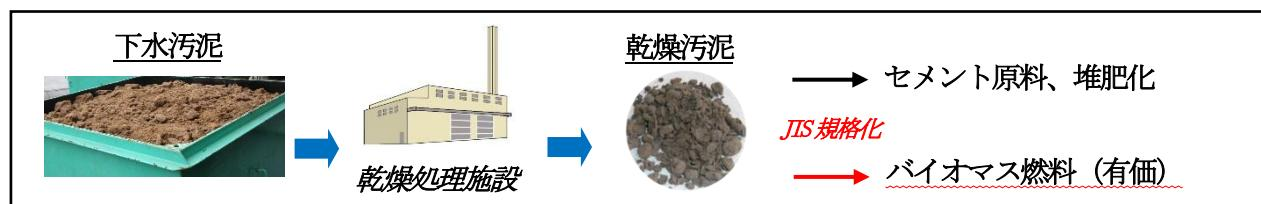
図 下水汚泥の処理フロー図
