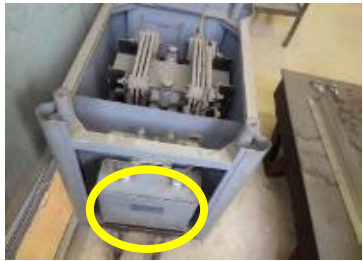
電気溶接機の側面に取り付けられた低圧コンデンサー
