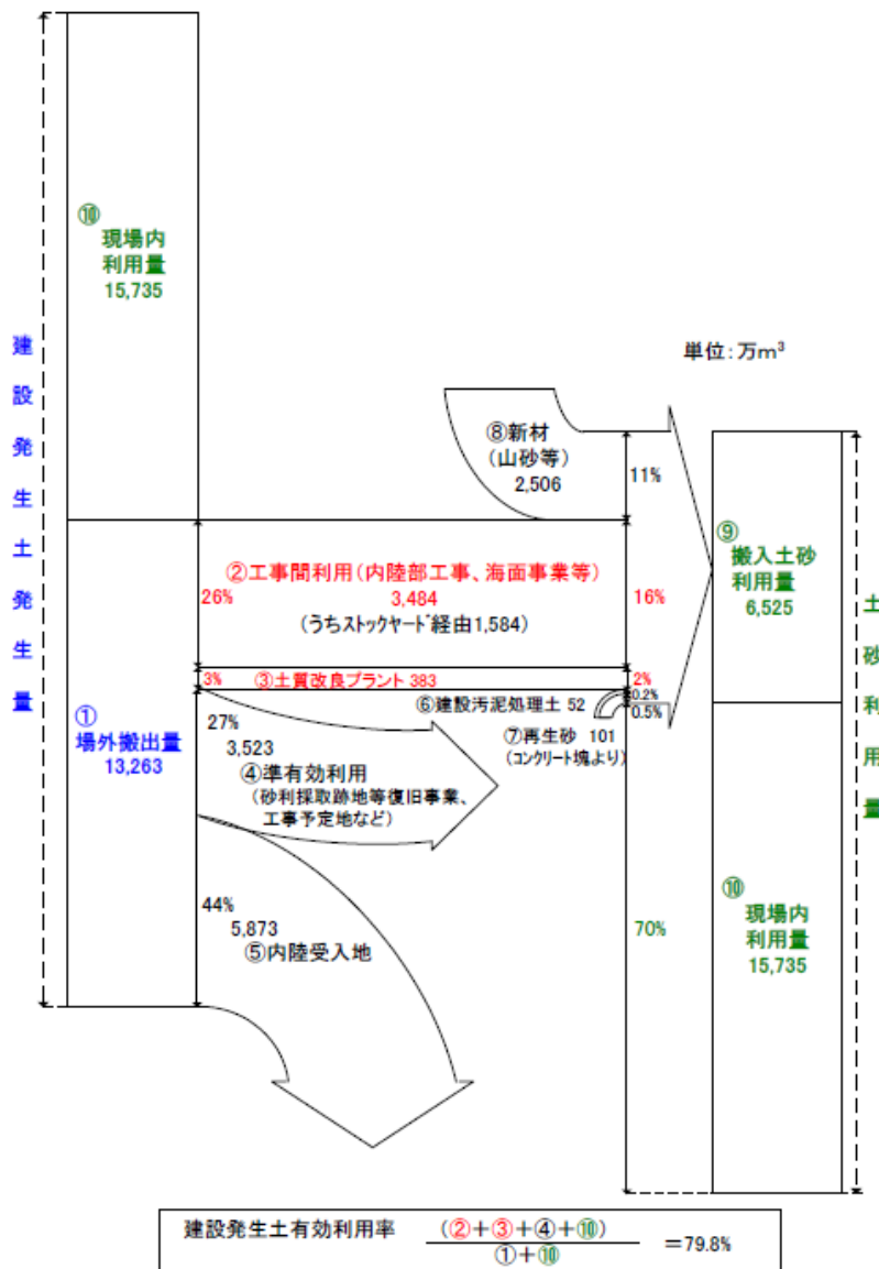
図14. 建設発生土搬出及び土砂利用搬入状況
