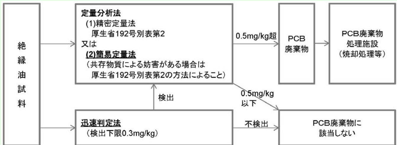
図 廃重電機器等に封入された絶縁油中の微量 PCB の測定方法
