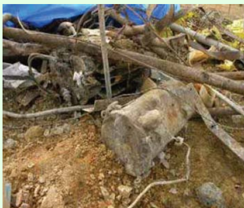
写真1 公園造成地に投棄されたPCB廃棄物からの漏洩事例(発見された電気機器)
