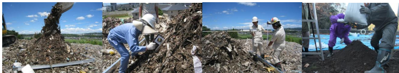
写真(2) 安息角試験の実施状況
