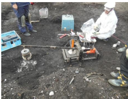
図 33 廃棄物地盤での一面せん断試験
