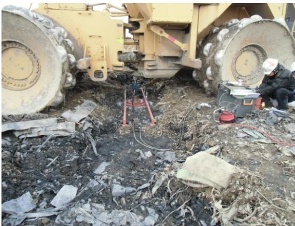
図 31 廃棄物地盤上での平板載荷試験 （載荷板径 1000\text{mm} ）
