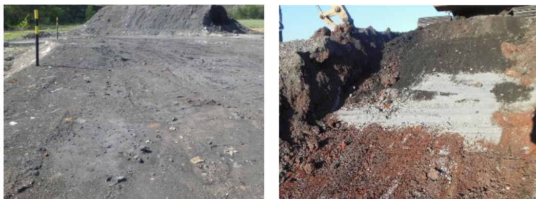
図 4 ③ 焼却灰、燃え殻等が主でプラスチック等をほとんど含まない地盤 (左; 表層 右; 試掘断面)
