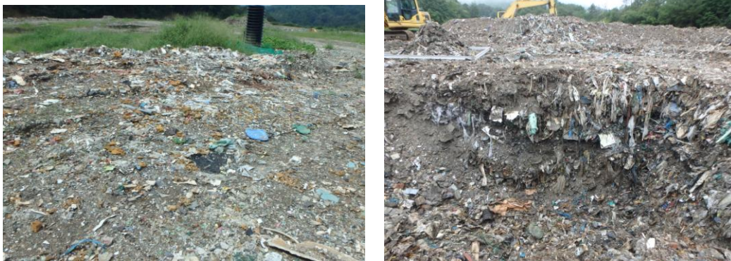
図 2 ① 10cm 超のプラスチック等の繊維状物等を多く含む地盤 (左; 表層 右; 試掘断面)
