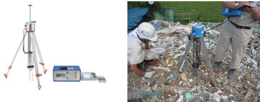
図 21 キャスポル（左；測定器の本体と表示部 右；測定状況）
