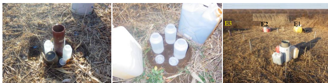
図 13 観測井戸脇（左図）及び地表部（中央図）に設置した純水ボトル及び放置状況（右図）
