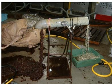
写真1 洗浄機の外観(側面)
