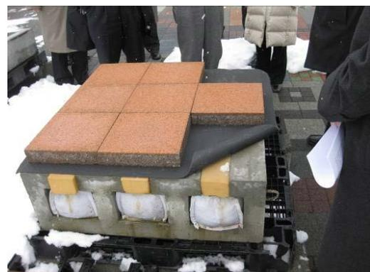
図 試作段階の透水・舗装システム
