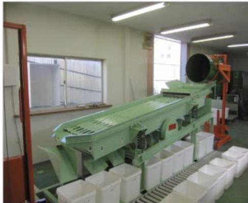
写真 電池選別機（テスト機）
