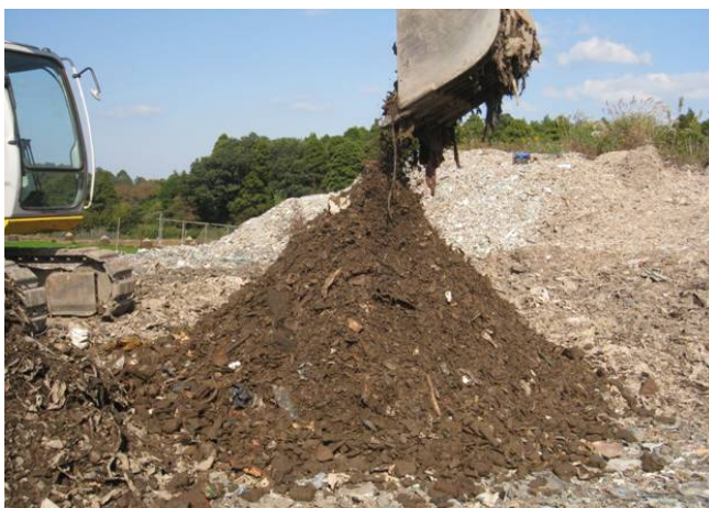
写真1 安息角試験(千葉現場)
