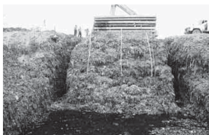
写真1 載荷実験(斜面高9m、勾配63.5°、載荷重8.6kN/m 2 )
