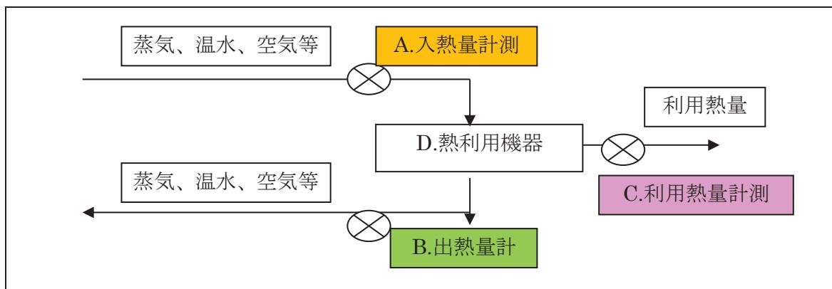
図1 热利用量の測定装置設置場所
