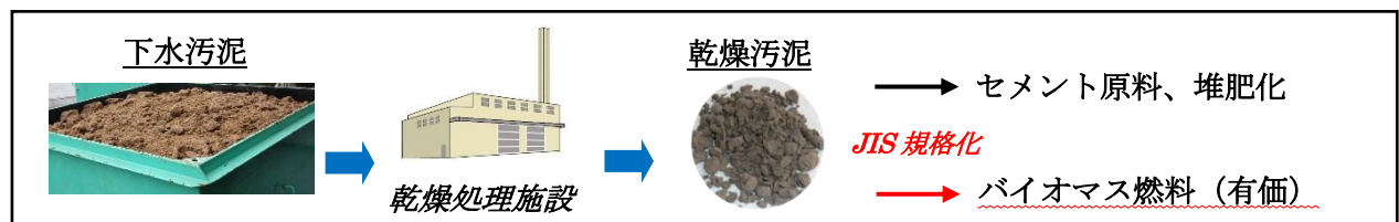
図 下水汚泥の処理フロー
