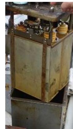
絶縁油槽に漬け込まれた低圧コンデンサー
