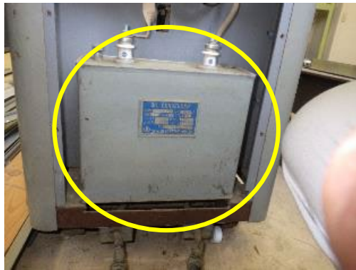
電気溶接機に設置された低圧コンデンサー
