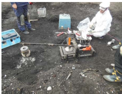
図 33 廃棄物地盤での一面せん断試験
