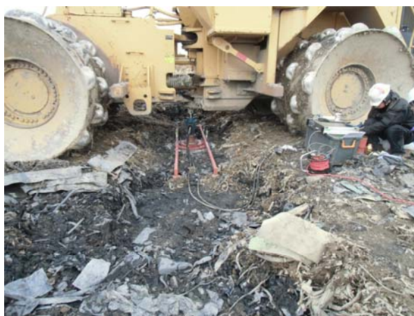
図 31 廃棄物地盤上での平板載荷試験 (載荷板径 1000mm)
