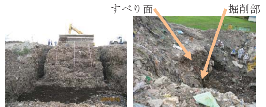
写真 1 載荷実験（上海）（既往計算法で安全率=0.56 だが斜面は安定） 写真 2 崩壊実験（中部①）（下側のトンネル状掘削で 40°の勾配で崩壊）
