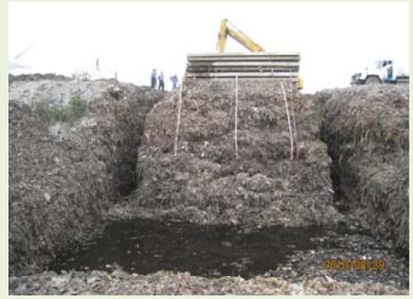
写真1 載荷実験(斜面高9m、勾配63.5°、載荷重8.6 kN/m²)
