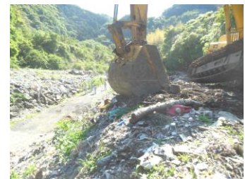
写真3 安息角試験(2箇所目) 写真4 法肩(勾配38°)への載荷
