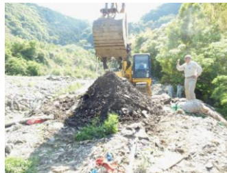
写真3 安息角試験(2箇所目) 写真4 法肩(勾配38°)への載荷
