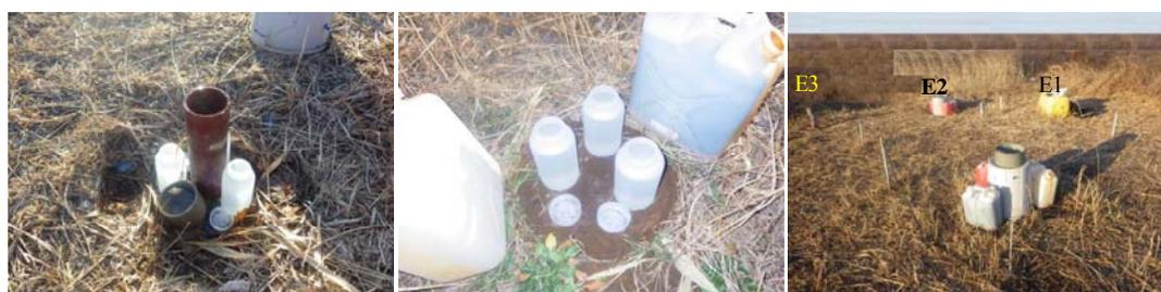
図 13 観測井戸脇（左図）及び地表部（中央図）に設置した純水ボトル及び放置状況（右図）
