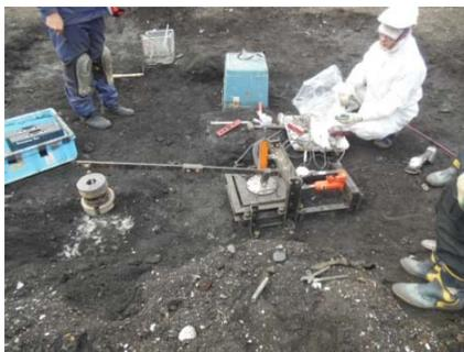
図 33 廃棄物地盤での一面せん断試験
