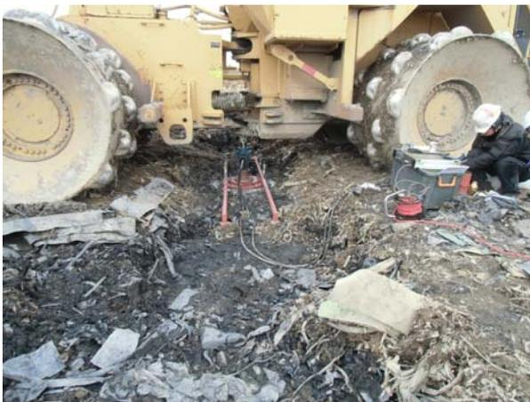
**図 31** 廃棄物地盤上での平板載荷試験
