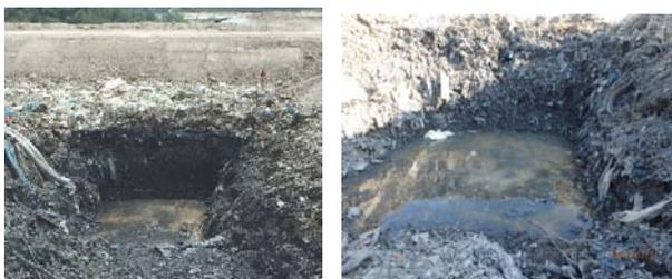
図 12 内部水位より 25m 高い地点での試掘後 6 時間後の湛水 (中部地方の安定型処分場)
