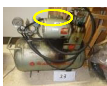
コンプレッサーに取り付けられた低圧コンデンサー
