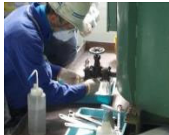
採取口付きの変圧器からの絶縁油の採取
