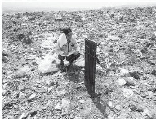
写真11 現場土圧試験
