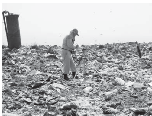
写真7 衝撃加速度試験(キャスポル)
