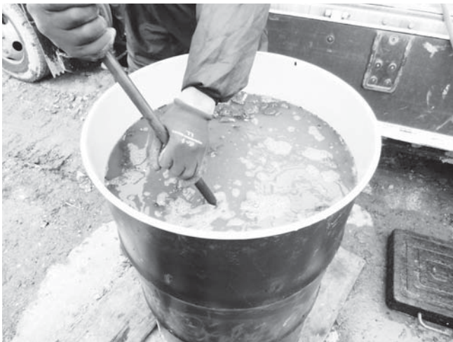
写真4 現場間隙率試験の空気抜き工程
