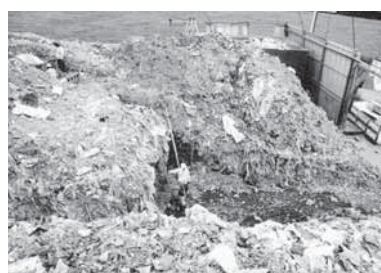
写真2 不法投棄等現場(中部地方)での崩壊実験 (左写真：矩形トンネル状の掘削 右写真：崩壊後)
