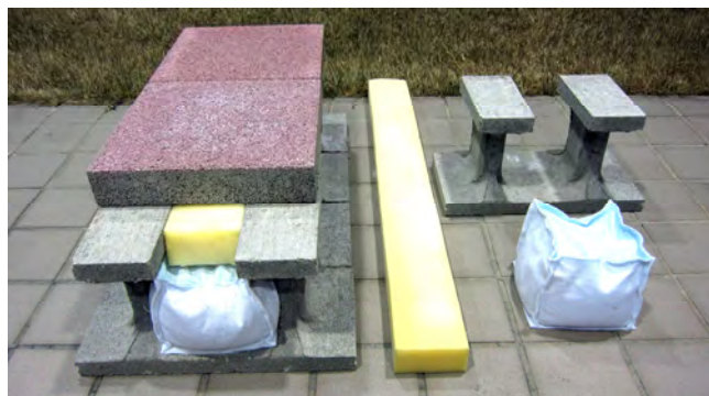
開発した透水性・保水性舗装(左：組み立てた状態、中央：スポンジ、右：保水材とコンクリート製ユニット)
