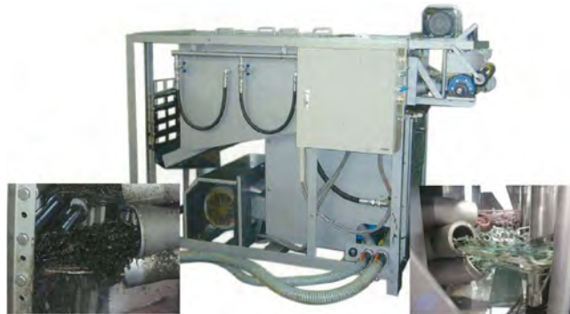
高圧洗浄機(中央)と のり網の洗浄効果(左：洗浄前、右：洗浄後)
