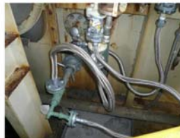
微量PCB専用吹込ランス (絶縁油)
