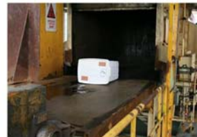
大型リフタ(投入) (紙くず・木くず・小型コンデンサ)
