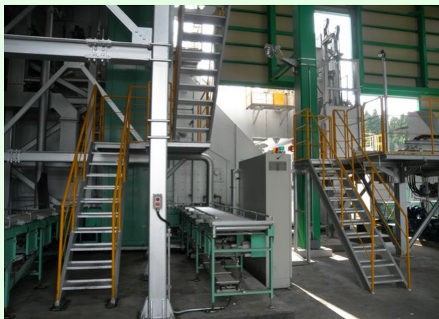
ドラム缶投入装置(右)と左が排出装置
