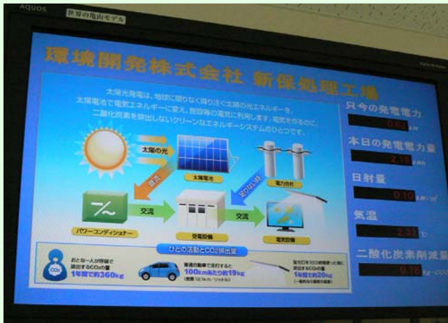
太陽光発電設備の発電量表示パネル
