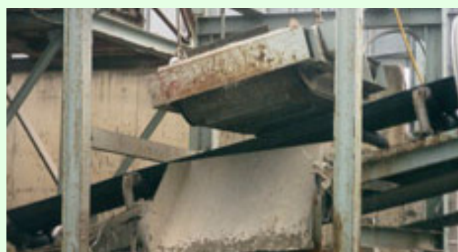
磁選機は、プロセス内に3ヵ所設置
