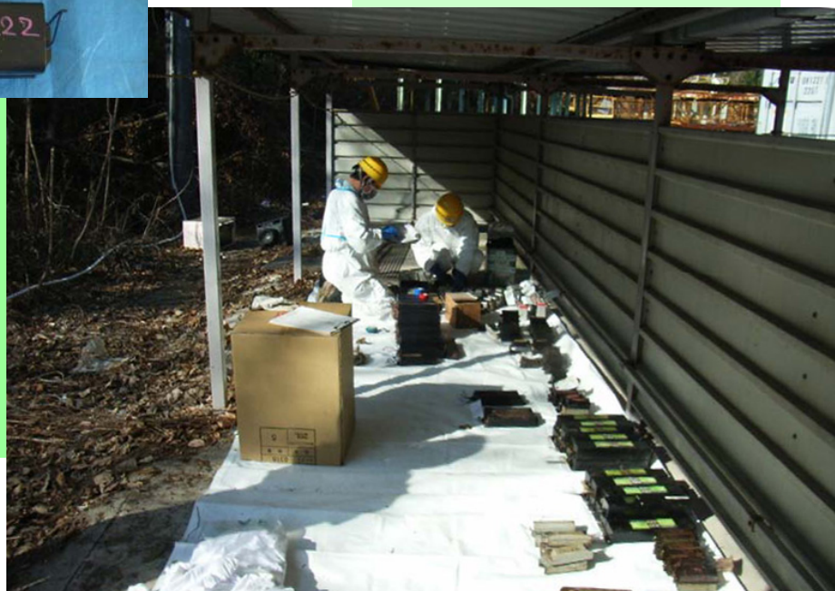
蛍光灯用安定器の調査・分別状況
