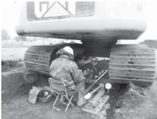
写真3 平板載荷試験
