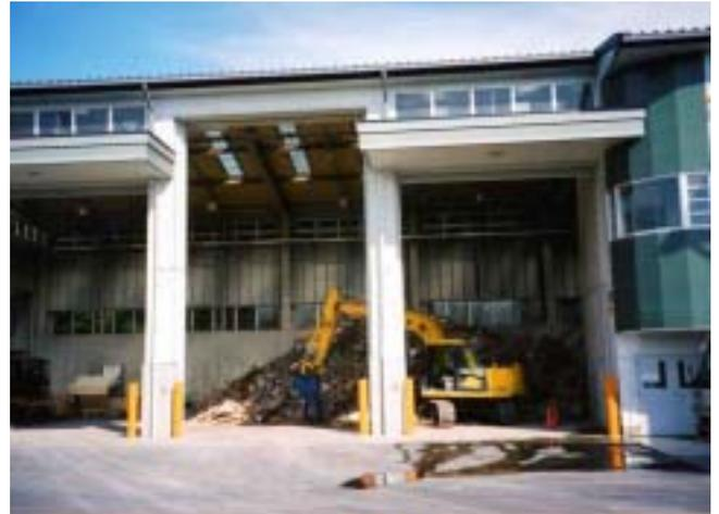
金属類、ダンボール紙、石膏ボードを選別、残った廃棄物は破砕機を経てピットに貯留
