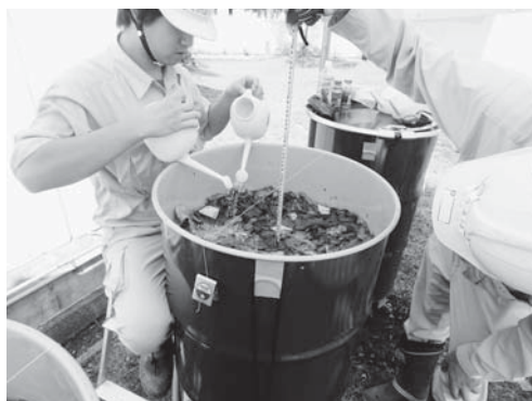
写真3 中部①現場試料によるカラムでの注水-排水実験
