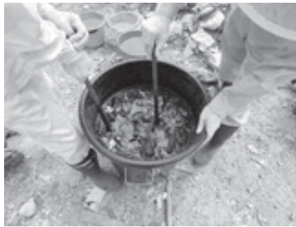
図9 現場空隙率試験 (GL.50m試料)
