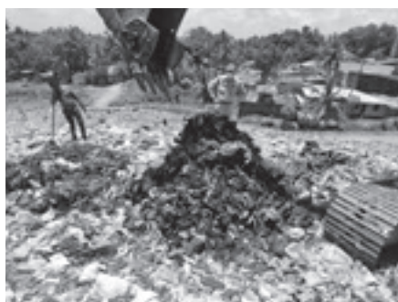
図5 安息角試験 (GL.30m)
