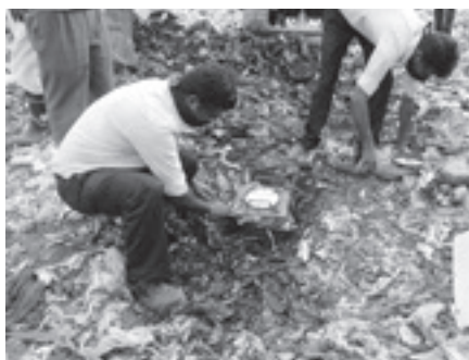
図3 一面せん断試験の供試体作成 (GL.20m)
