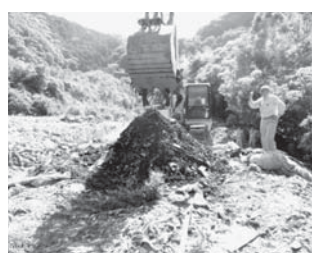
写真3 安息角試験(2箇所目) (試験を行う土居教授)
