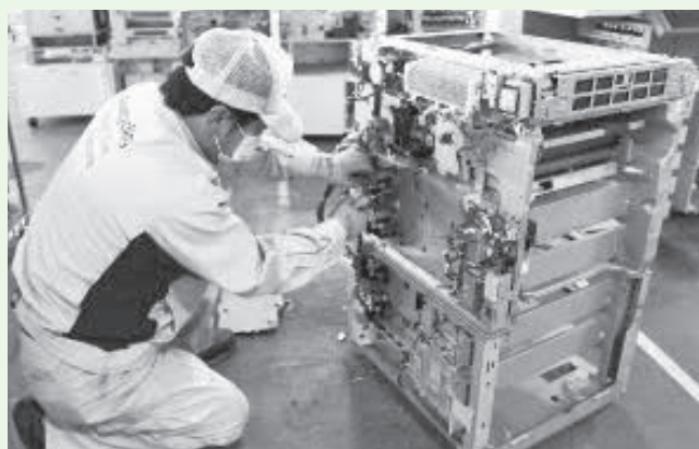
複合機手作業解体の作業風景
