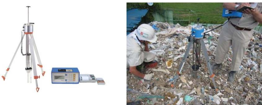
図9 キャスボル (左；測定器の本体と表示部　右；測定状況)
