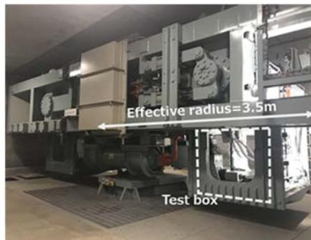
図参1(a) 動的遠心載荷実験装置
