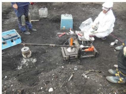
図5 廃棄物地盤での一面せん断試験
