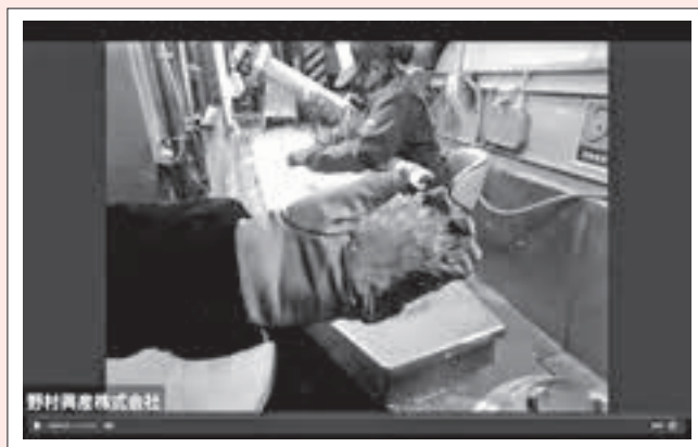
写真6 廃蛍光管の破碎・洗浄後のガラスカレット
