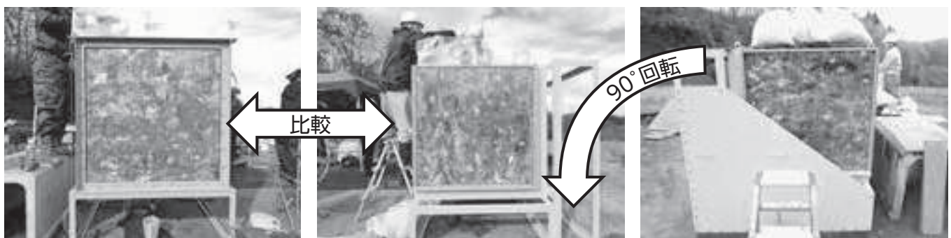
図1 1m 3 土槽を用いた異方性確認実験(左：標準土槽、中：90°回転後、右：90°回転前)
